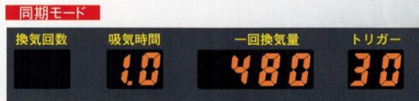
30:2と吸気時間1.0秒(変更可)での設定メトロノーム(音と数字カウント)終了後に設定された吸気時間1秒で設定換気量を2回連続換気します。
