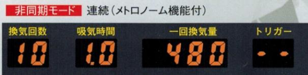
胸骨圧迫は100回/分のメトロノーム(音)とともに任意に換気量、換気回数及び吸気時間を簡単に設定できます。
